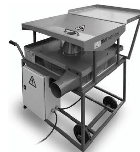
RMT-NITA CAR 103 : alimentation automatique, réglage de la quantité de matière, variateur de puissance (air)
