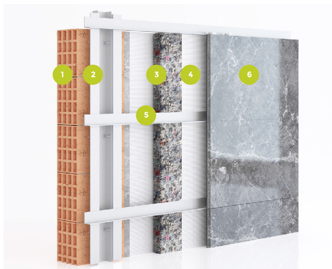
Posible instal·lació en fachada ventilada.
