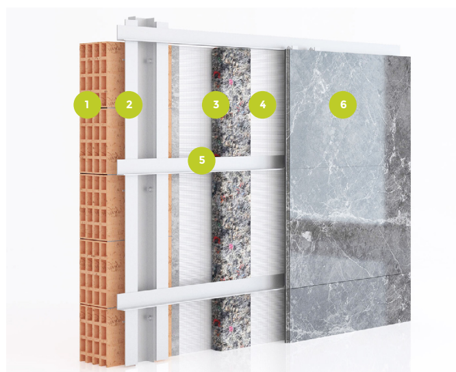
Posible instalación en fachada ventilada.
